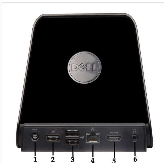
Afbeelding 2. Achteraanzicht docking station
